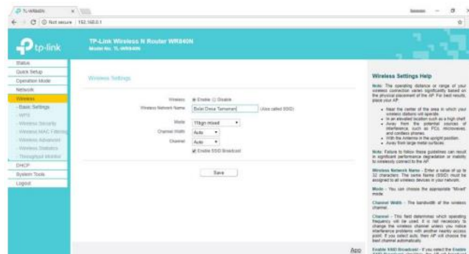
Gambar 8. Konfigurasi SSID Access Point Gambar 8 Konfigurasi SSID Access Point, ganti SSID yang semua default dengan Balai Desa Tamanan
