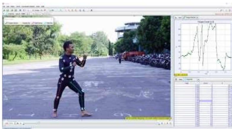
Gambar 3. Proses pengujian gerakan video referensi
